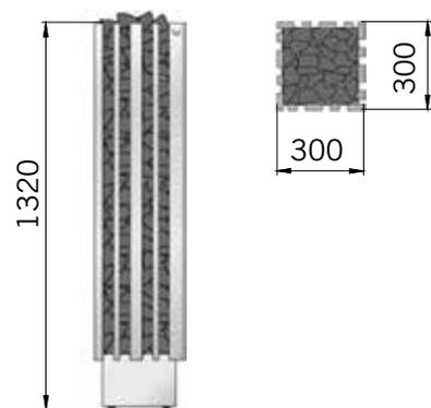
Abmessungen IKI Monolith 6,9 und 9 kW
