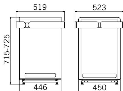
**Abmessungen Concept R 9 und 10,5 kW**
