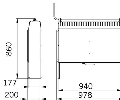
**Abmessungen Hinterwandöfen 8, 9 und 10,5 kW**
