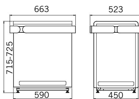
**Abmessungen Concept R 12 kW und 15 kW**
