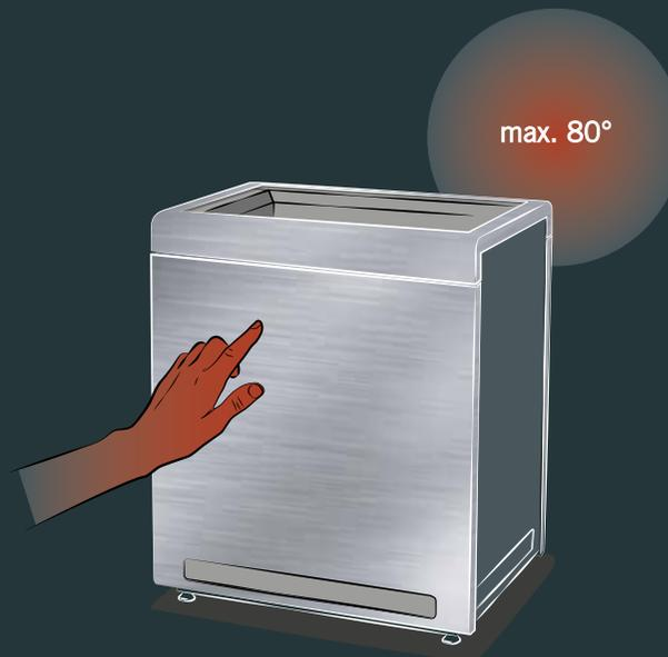
Durch die angewandte 3-Mantel-Technik erreicht der Concept R Saunaofen auf dem Außenmantel Temperaturen von max. 80° C.
