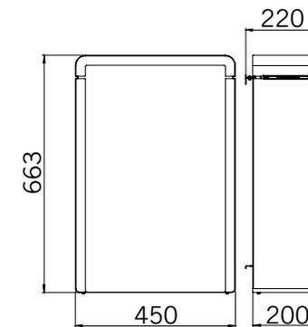
**Abmessungen Zusatzverdampfer R**
