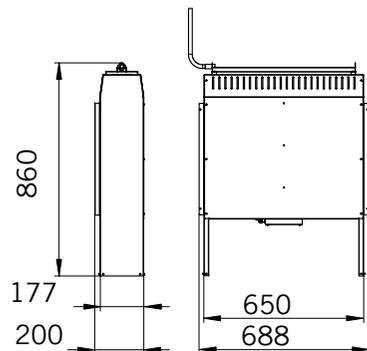
**Abmessungen Hinterwandöfen 3,5, 4,5 und 6 kW**
