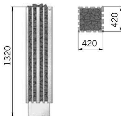
Abmessungen IKI Monolith 13,8, 15,9 und 18 kW
